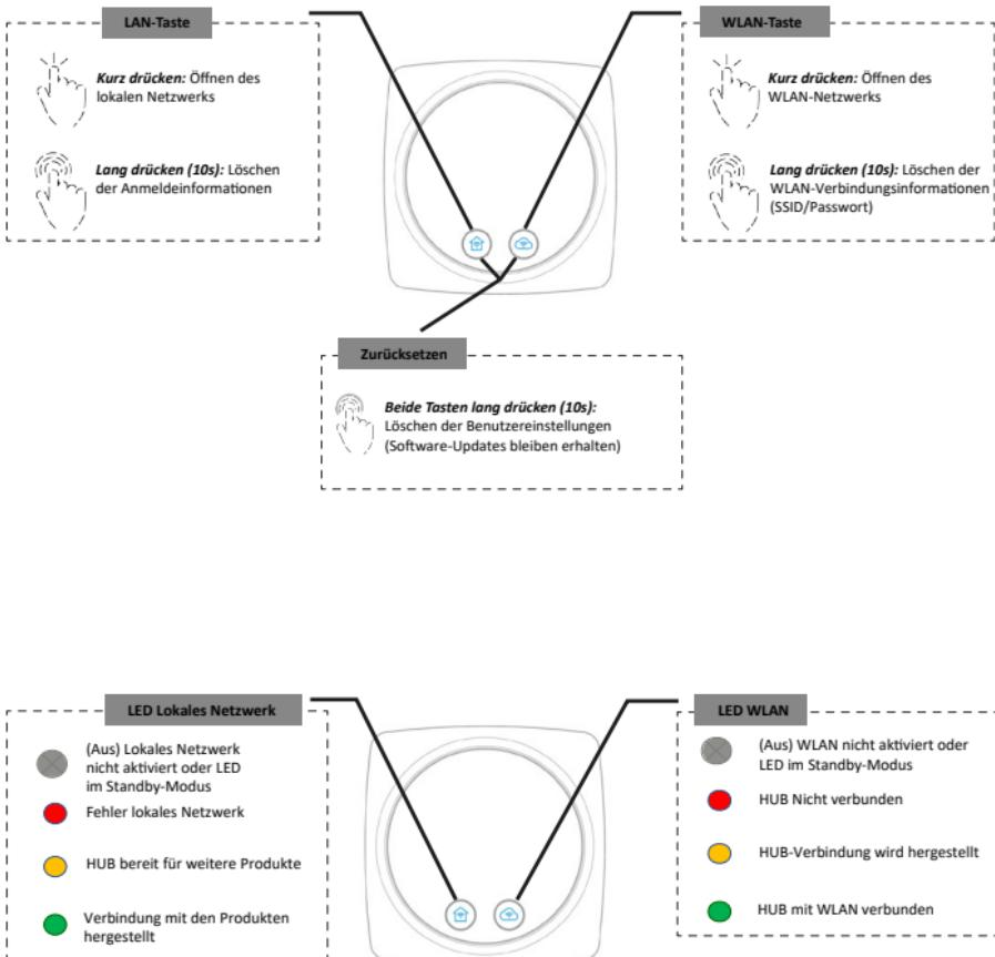
Nach 5 min Inaktivität erlöschen die LEDs. Der HUB befindet sich im Standby-Modus. Drücken Sie eine beliebige Taste, um den Standby-Modus zu beenden.
