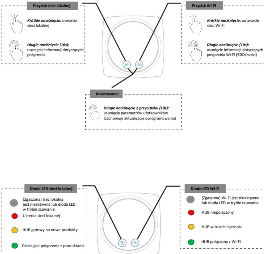
Po około 5 minutach bezczynności, lampki kontrolne gasną. HUB jest w trybie czuwania. Nacisnąć na przycisk, aby wyjść z trybu czuwania.
